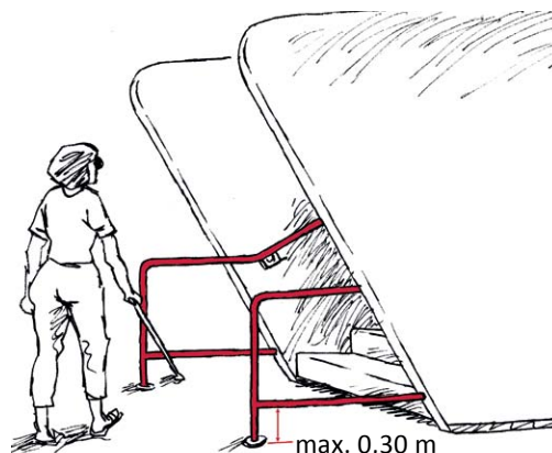
Abschränkung auskragender Elemente mit Geländer
